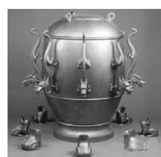
中国很久以前就有了可以知道地震方向的仪器, 它是张衡在132年发明的。这个仪器上有八条龙, 龙头向下, 对着八个方向。龙嘴里有球, 哪个方向有了地震, 那个方向的球就会掉出来。138年中国西边的甘肃省有了地震, 西边龙嘴里的球真的掉了出来。
